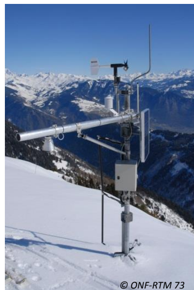
Photo 20 : Station nivométéo GAZEX, CG73 Celliers
