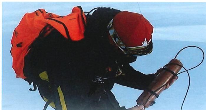
Cet outil permet de réaliser un perçage uniforme de la charge, avant amorçage, selon la longueur et le diamètre validés par l'**ANENA**.
